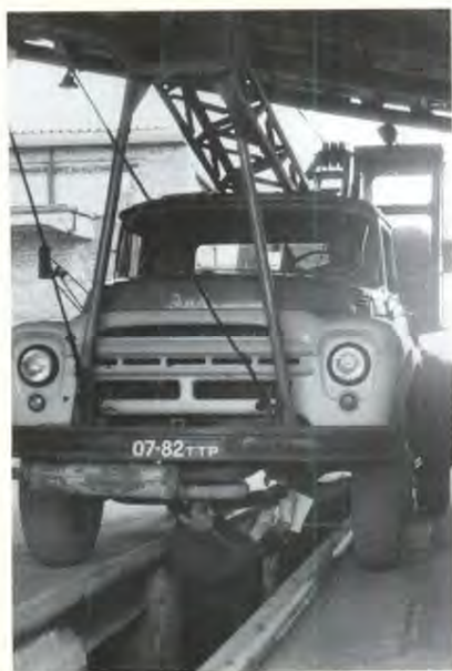
Техническое обслуживание автокрана на базе ЗИЛ-130
